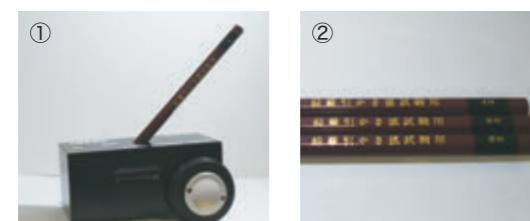
①オールグッド社製JIS規格対応鉛筆硬度試験機
