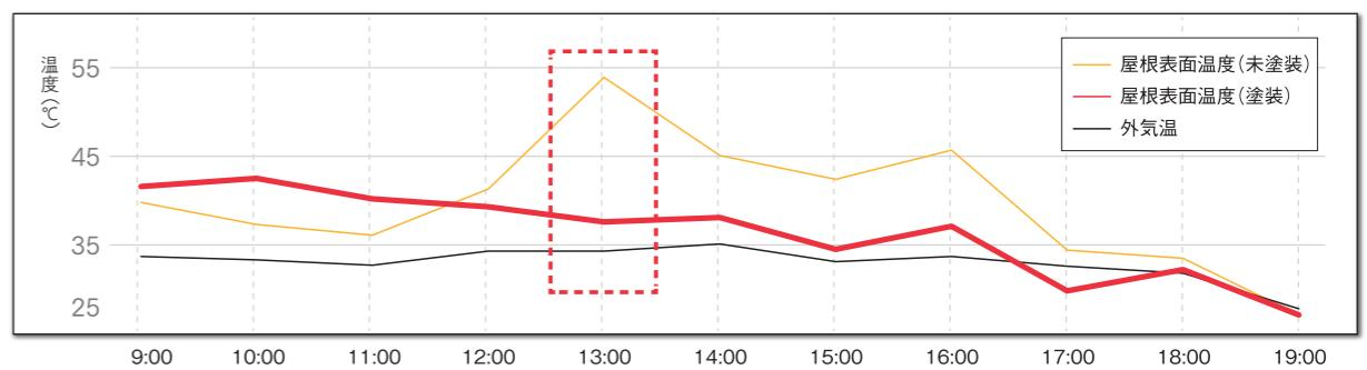
13:00に計測した時点で、未塗装面の屋根表面温度53.9°Cに対して、超低汚染リファイン塗装面の屋根表面温度37.6°Cを計測しました。
